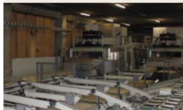
Die beiden Hochfrequenzpressen in Pfeifers Brettschichtholz-Produktion
