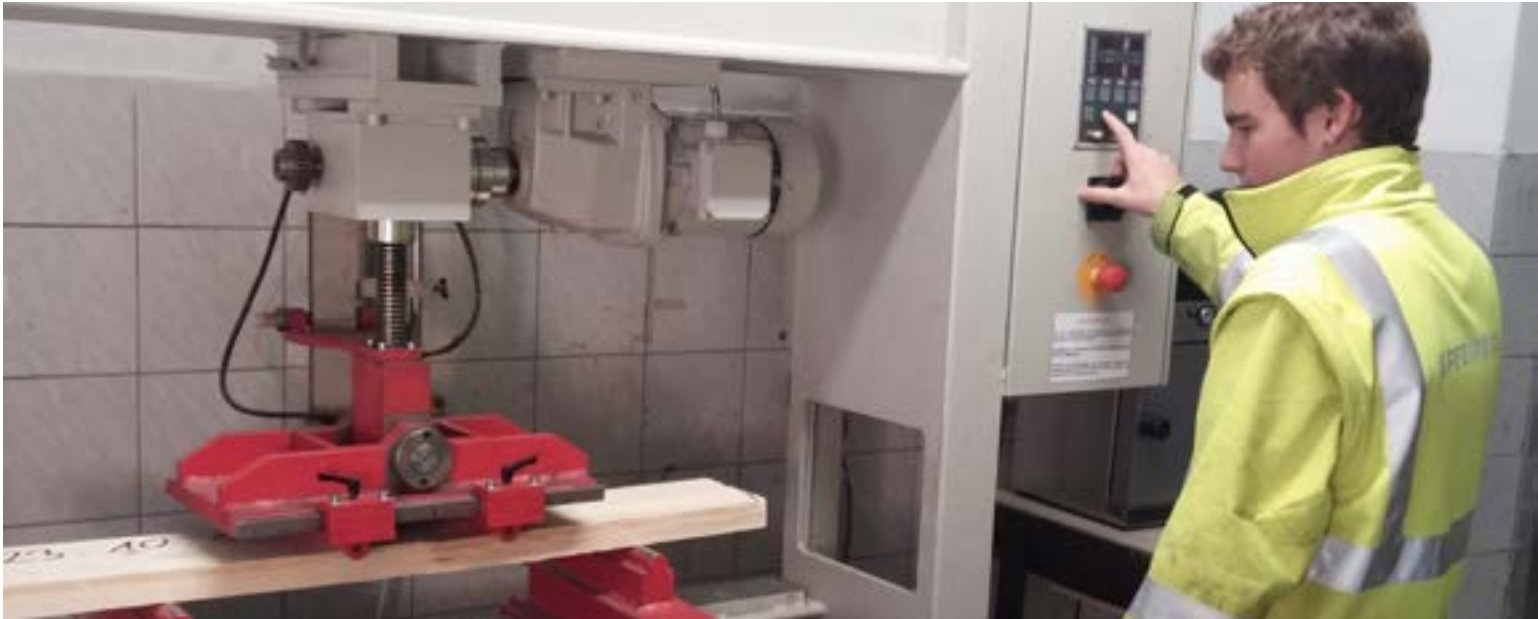
Jack Gilsing beim Durchführen einer Biegeprüfung.
