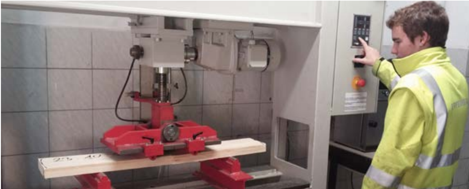
Jack Gilsing durante l'esecuzione di un test di flessione.
