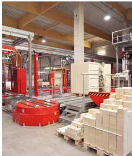
Aus naturbelassenen Holzspänen, Leim, Wachs und Härter entsteht ein unentbehrliches Basisprodukt für eine funktionierende Warenlogistik.
