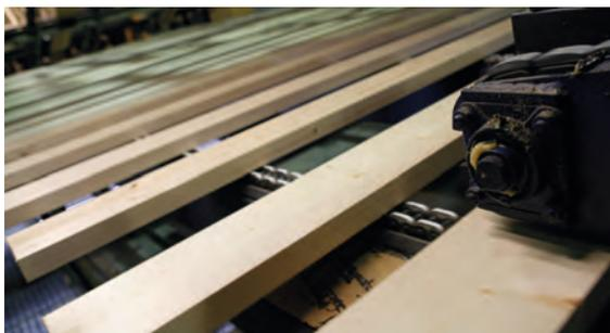
Le triage du bois de sciage se fait visuellement et directement après la découpe sur des trieuses performantes par du personnel de tri formé en continu, appuyé par une technologie moderne de scanners. Les dimensions sont toujours emballées séparément selon l'épaisseur, la largeur, la longueur et la qualité.
