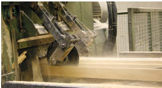
Sciage sur ligne de canter modernes Link et EWD équipées exclusivement de scies circulaires pour garantir des surfaces lisses, une précision de coupe et une exactitude des dimensions.
