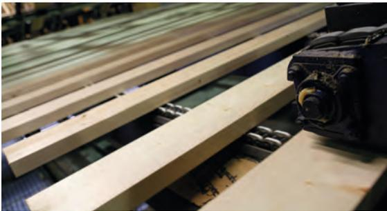
Die Schnittholzsortierung erfolgt visuell direkt nach dem Einschnitt auf leistungsfähigen Sortieranlagen durch laufend geschultes Sortierpersonal, unterstützt durch moderne Scannertechnologie. Dimensionen werden immer nach Stärke, Breite, Länge und Qualität getrennt packetiert.
