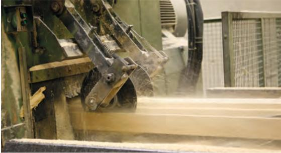
Einschnitt auf modernen Link und EWD Spaner-Profilier-Sägelinien ausschließlich mit Kreis-sägenschnitt. Dadurch sind glatte Oberflächen, Schnittgenauigkeit und Maßhaltigkeit gewährleistet.
