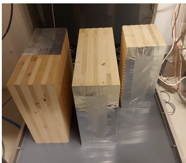
Abbildung 1: Die Probe 500038_21 in der 1 m 3 Normprüfkammer
