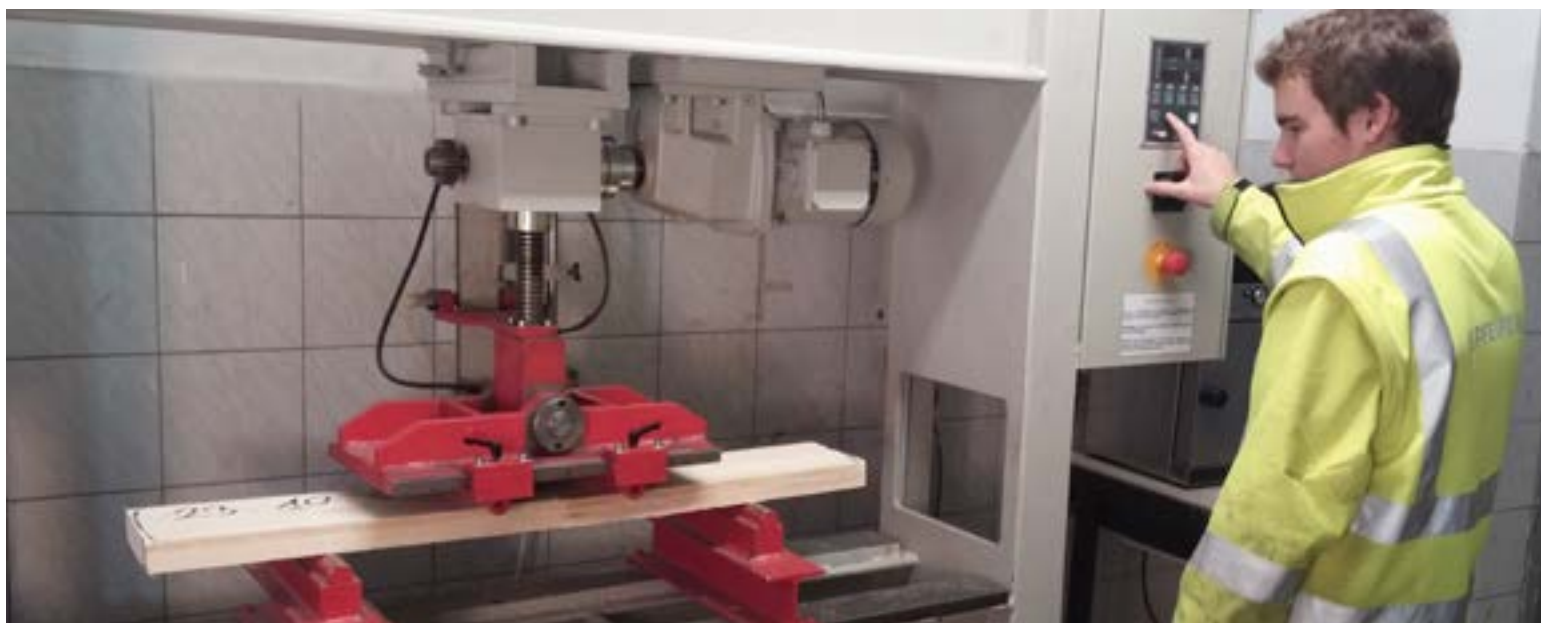
Jack Gilsing při provádění ohybové zkoušky.
