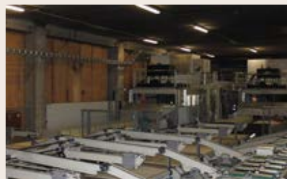
Oba vysokofrekvenční lis ve výrobě lepených lamelových dřev firmy Pfeifer.
